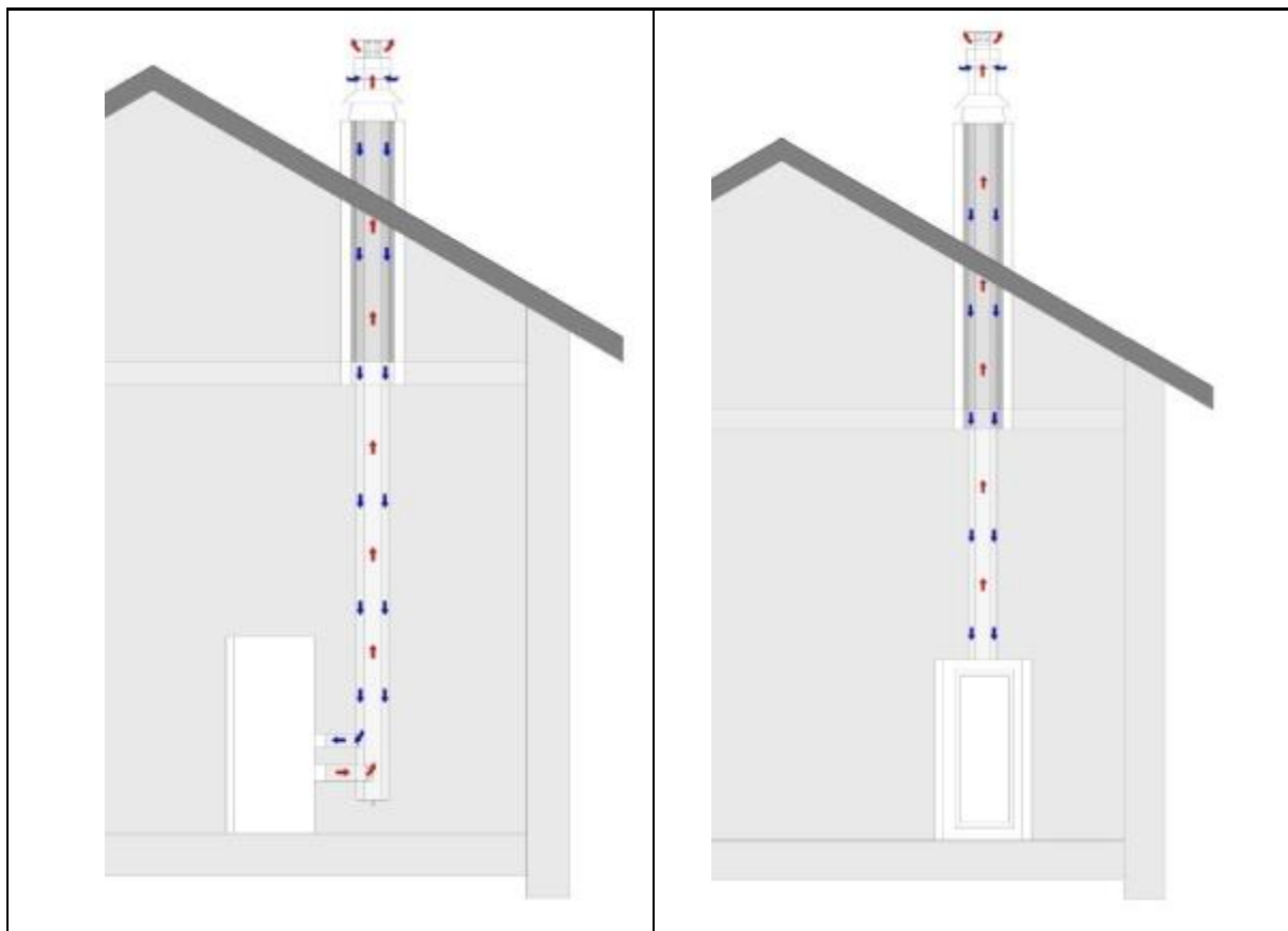
Figure 1c – Montage d'un conduit concentrique dans un conduit de fumée existant
